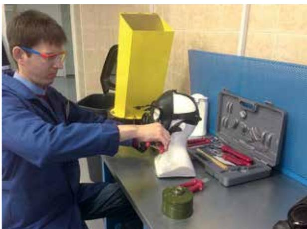
Утилизация противогазов и противогазных коробок с помощью специально сконструированного стенда
