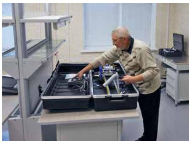
Подготовка к работе мобильной установки по контролю радиационно-химической обстановки
