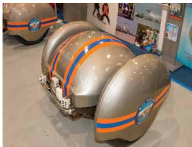
Мультиагентный робототехнический комплекс разведки и мониторинга аварийных утечек, проливов и возгораний
